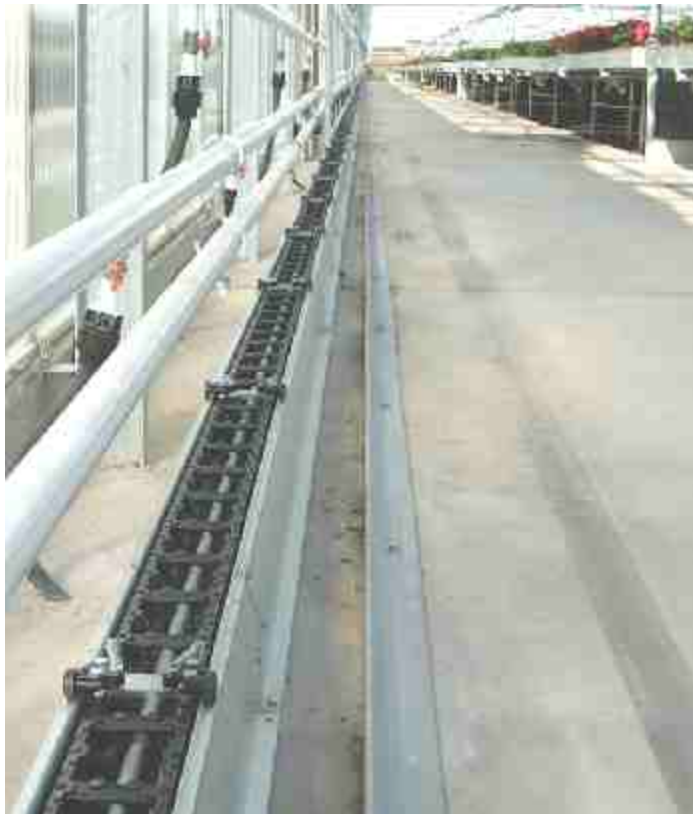
Anwendungsbeispiel Gewächshaus: Relative Luftfeuchtigkeit 80-100% Verfahrweg 150 m
